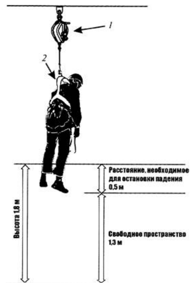
Рис. 5.2 Пример расчёт запаса высоты при использовании жёсткой анкерной линии, установленной с фактором
